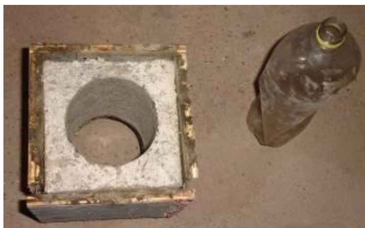
Figura 58 – Desmoldagem dos blocos.
