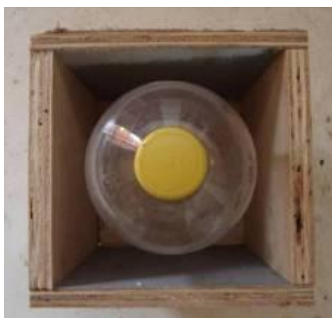
Figura 56 – Vista superior das fôrmas em madeira do meio bloco.
