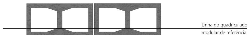
Figura 26 - Componente em posição assimétrica em relação à linha do quadriculado modular de referência Fonte: Baldauf (2004)
