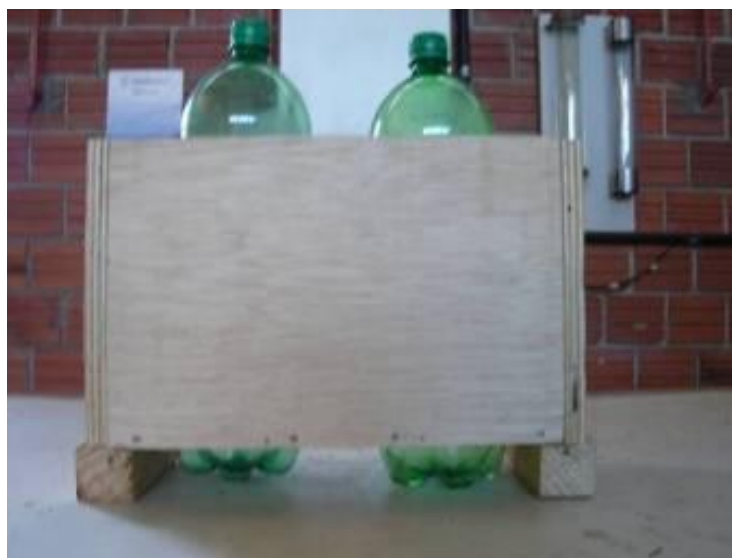
Figura 55 – Vista frontal das fôrmas em madeira do bloco inteiro.
