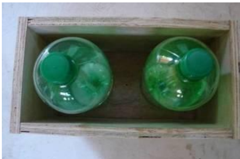
Figura 54 – vista superior das fôrmas em madeira do bloco inteiro.
