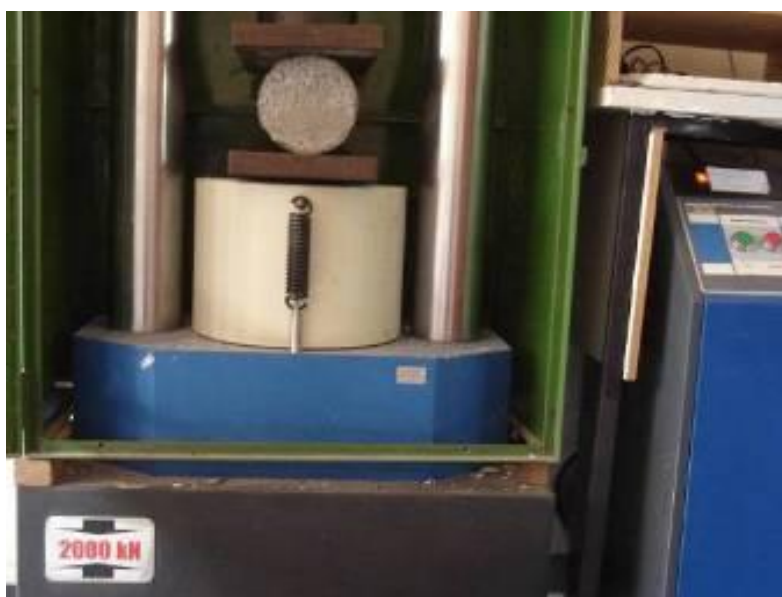
Figura 46 - Ensaio de resistência mecânica por compressão diametral.
