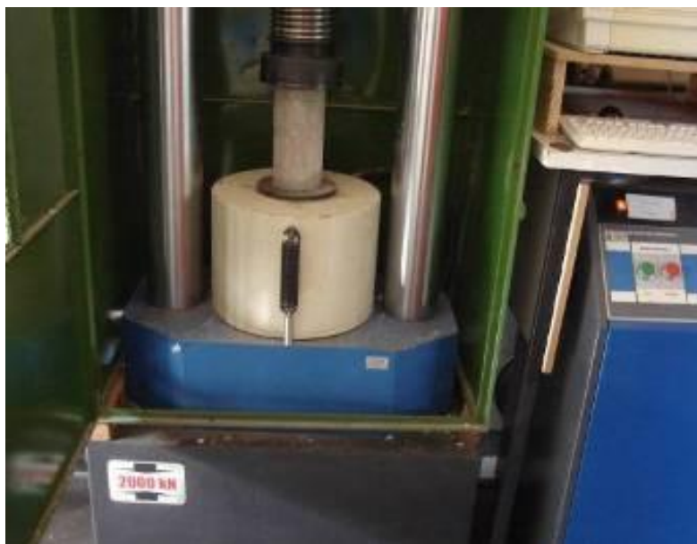
Figura 45 - Ensaio de resistência mecânica à compressão simples.
