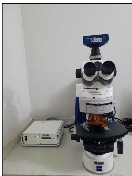
Figura 3 – Microscópio de fluorescência acoplado à câmera utilizado para a visualização dos filtros obtidos na análise e captura das partículas fluorescentes
