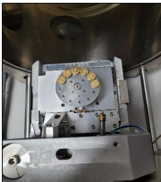
Figura 4 – Stubs posicionados para a geração de imagens por MEV pelo método do elétron secundário
