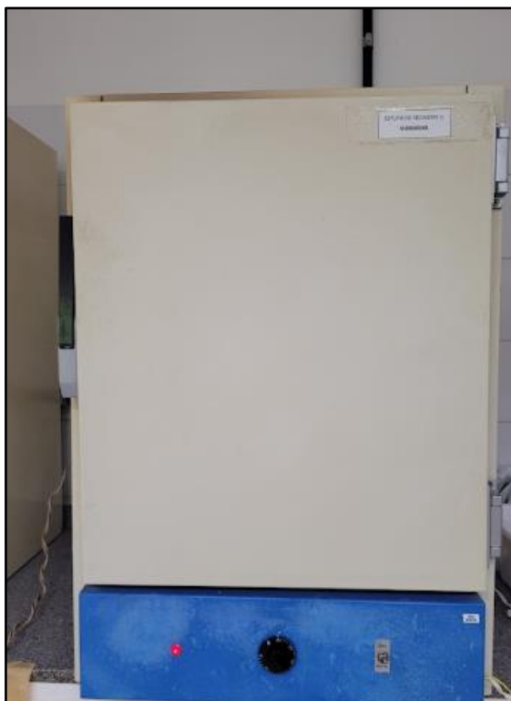
Figura 2 – Estufa de secagem utilizada no protocolo de remoção de matéria orgânica dos filtros analisados no estudo
