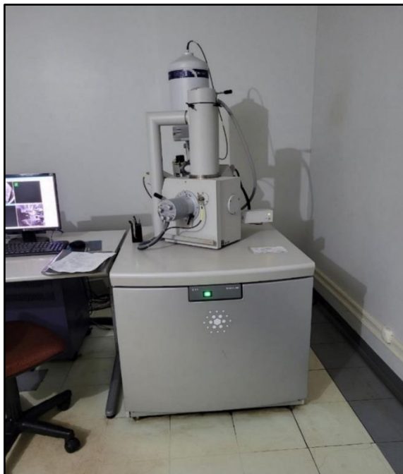
Figura 3 – Microscópio Eletrônico de Varredura utilizado para a análise detalhada de fragmentos e fibras selecionados
