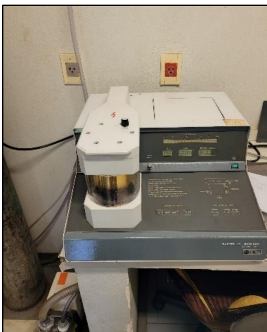
Figura 2 – Equipamento sputter coater (revestidor por pulverização catódica), onde é realizado o revestimento de ouro nas amostras a serem analisadas
