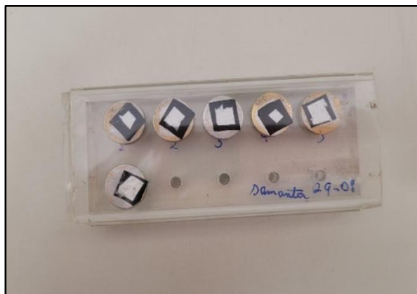
Figura 1 – Stubs com partículas aderidas à fita dupla face de carbono previamente ao revestimento de ouro
