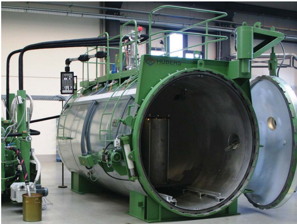
Figura 4 - Autoclave para encapsulamento de bobinas (Fonte: Hübers)
