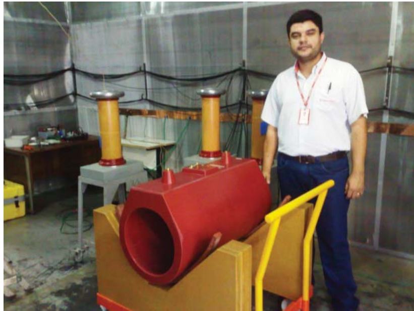
Figura 21 - Ensaio de medição de descargas parciais por tensão aplicada em bobinas de média tensão encapsuladas (Fonte: Acervo próprio)
