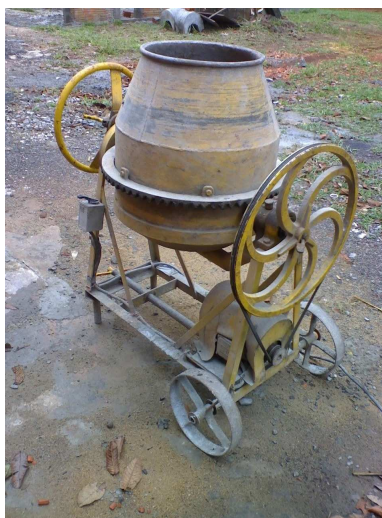
Figura 4.2: Betoneira utilizada nos ensaios.
