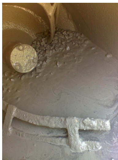
Figura 4.3: Mistura de concreto com segregação evidente.
