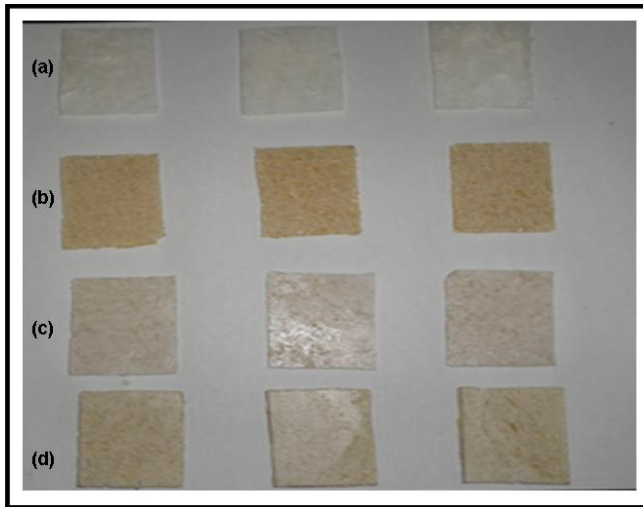
Figura 24 – Corpos de prova (30 x 40 mm) das bandejas de amido de mandioca, fibras do bagaço de cana-de-açúcar e nanoargilas do teste de biodegradação em solo: (a) Controle 1; (b) F20.0; (c) MMT5.0; (d) F20MMT5.0.
