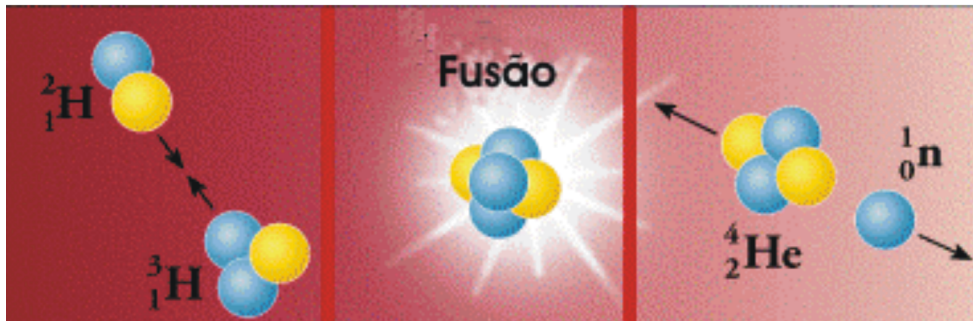
Figura 9 – Esquema de fusão nuclear do ^2\text{H} e ^3\text{H} (adaptado de http://www.lbl.gov/abc/wallchart ).
