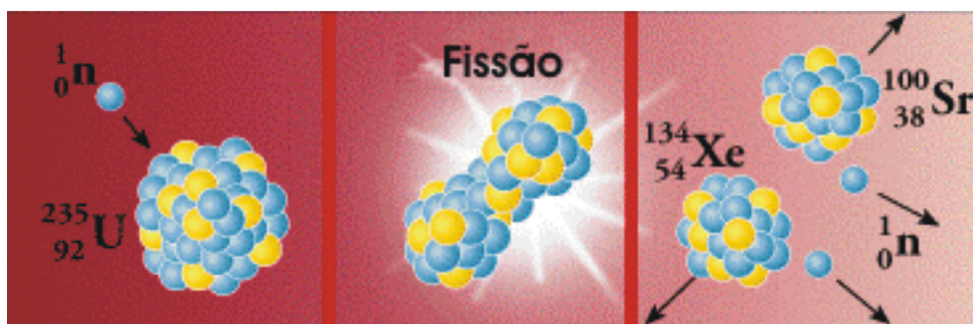
Figura 8 – Esquema de fissão nuclear do ^{235}\text{U} , criando o ^{100}\text{Sr} e o ^{134}\text{Xe} (adaptado de http://www.lbl.gov/abc/wallchart ).
