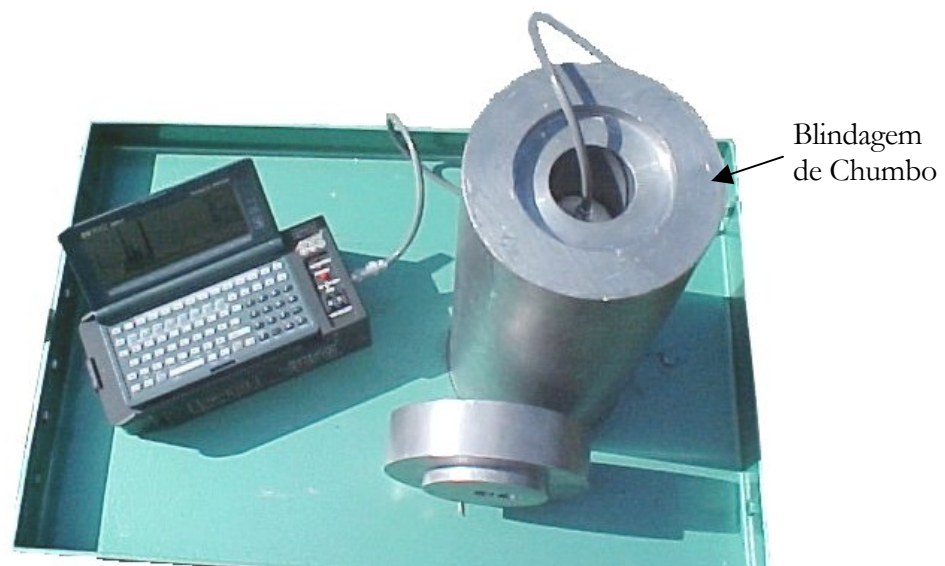
Figura 34 – Mesa de medidas da espectrometria gama in situ do LFNA.
