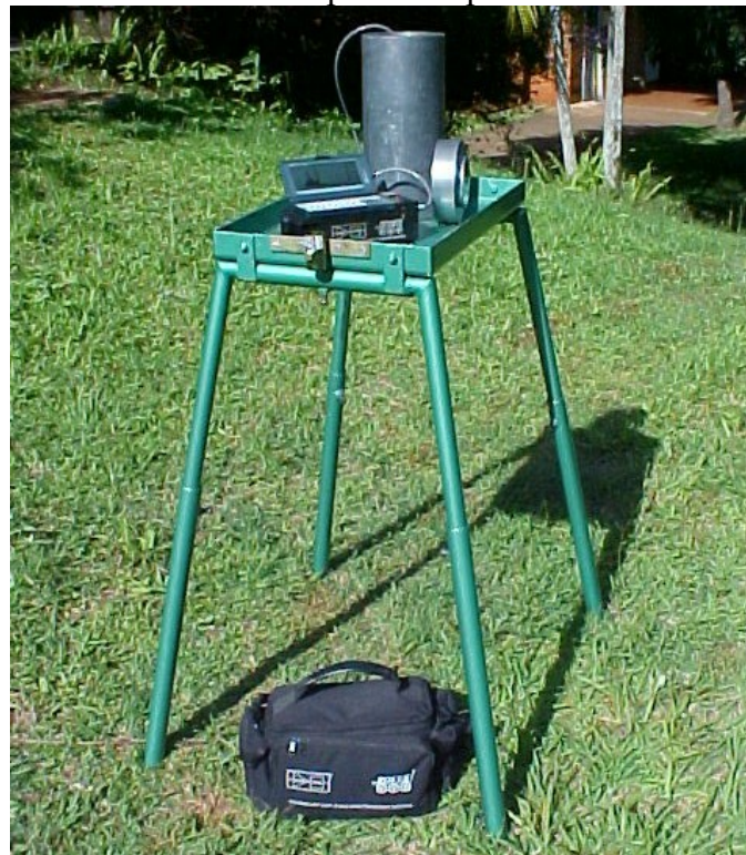
Figura 39 – Sistema de espectrometria gama in situ do LFNA.
