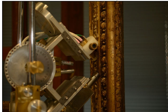
Figura 17 - Detector e Tubo de raios X utilizados nas medidas realizadas no MASP, Brasil
