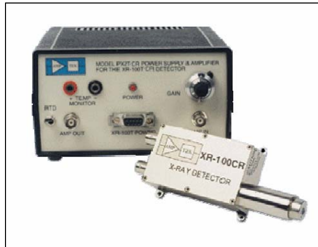
Figura 15 - Detector XR-100CR e Amplificador, utilizados nas medidas realizadas no Brasil
