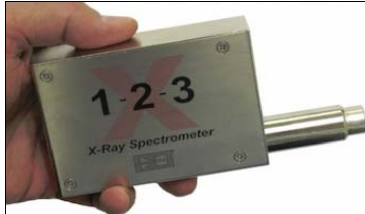
Figura 12 - Detector modelo X-123SDD, utilizado nas medidas realizadas no Peru
