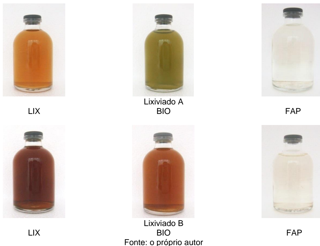
Figura 24 - Fotos dos lixiviados bruto (LIX), de estudo (BIO) e pós-tratados por FAP (FAP) A e B, respectivamente
