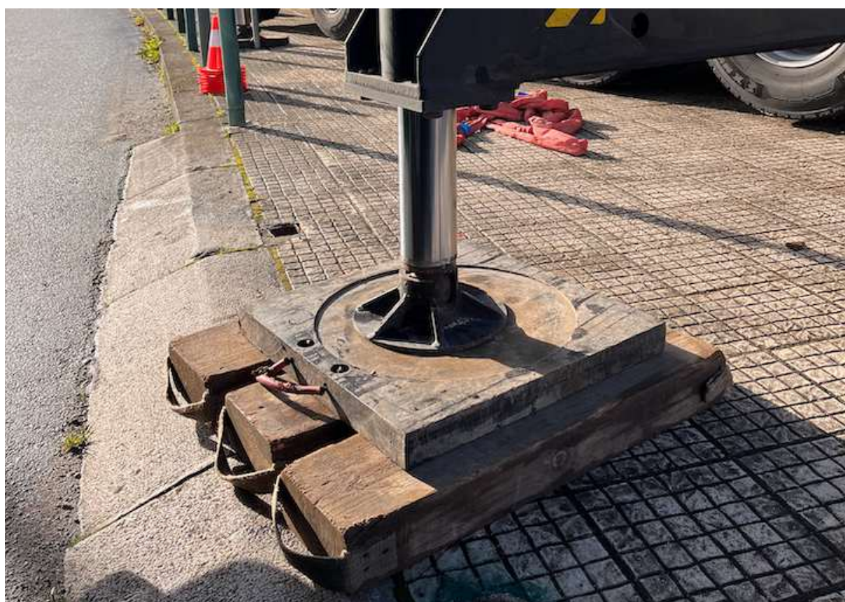
Figura 9 - Elementos auxiliares de apoio utilizados sob a sapata do estabilizador do guindaste tipo Munck
