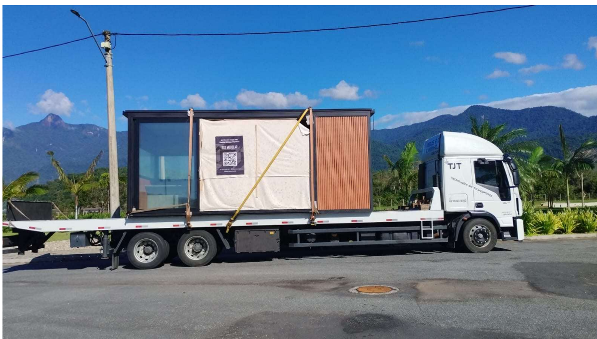
Figura 15 - Módulo transportado em caminhão truck plataforma durante a operação analisada no segundo ciclo de avaliação.
